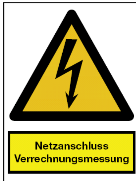
Bild 2 Musterschild zur Kennzeichnung von A- und AV-Schränken
